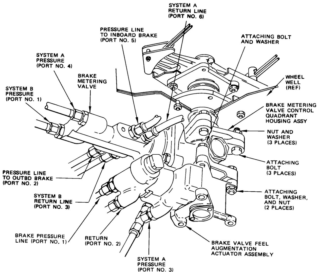
BRAKE METERING VALVE AND BRAKE VALVE FEEL
