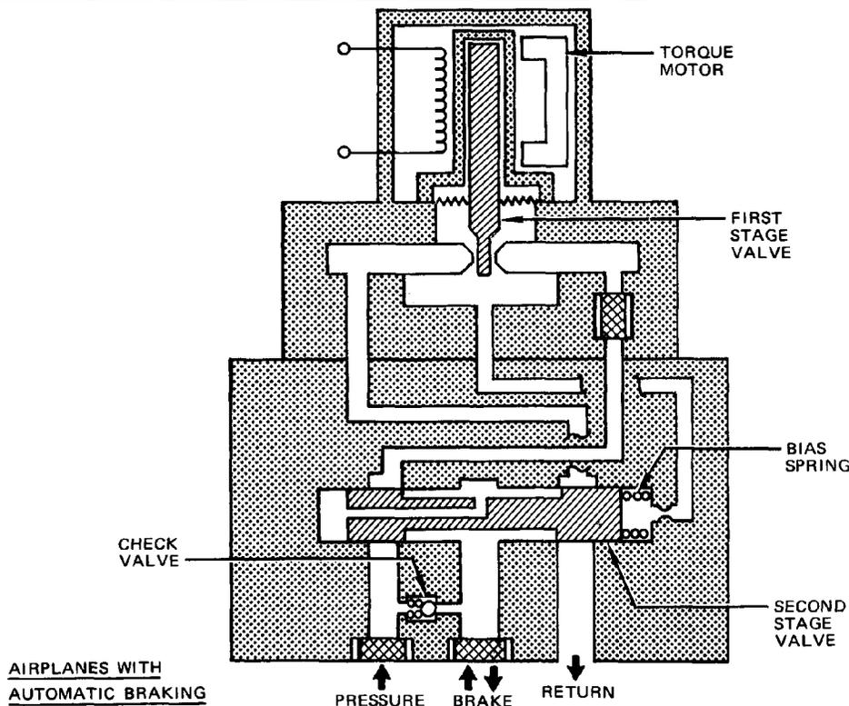
**Antiskid Control Valve Schematic**
