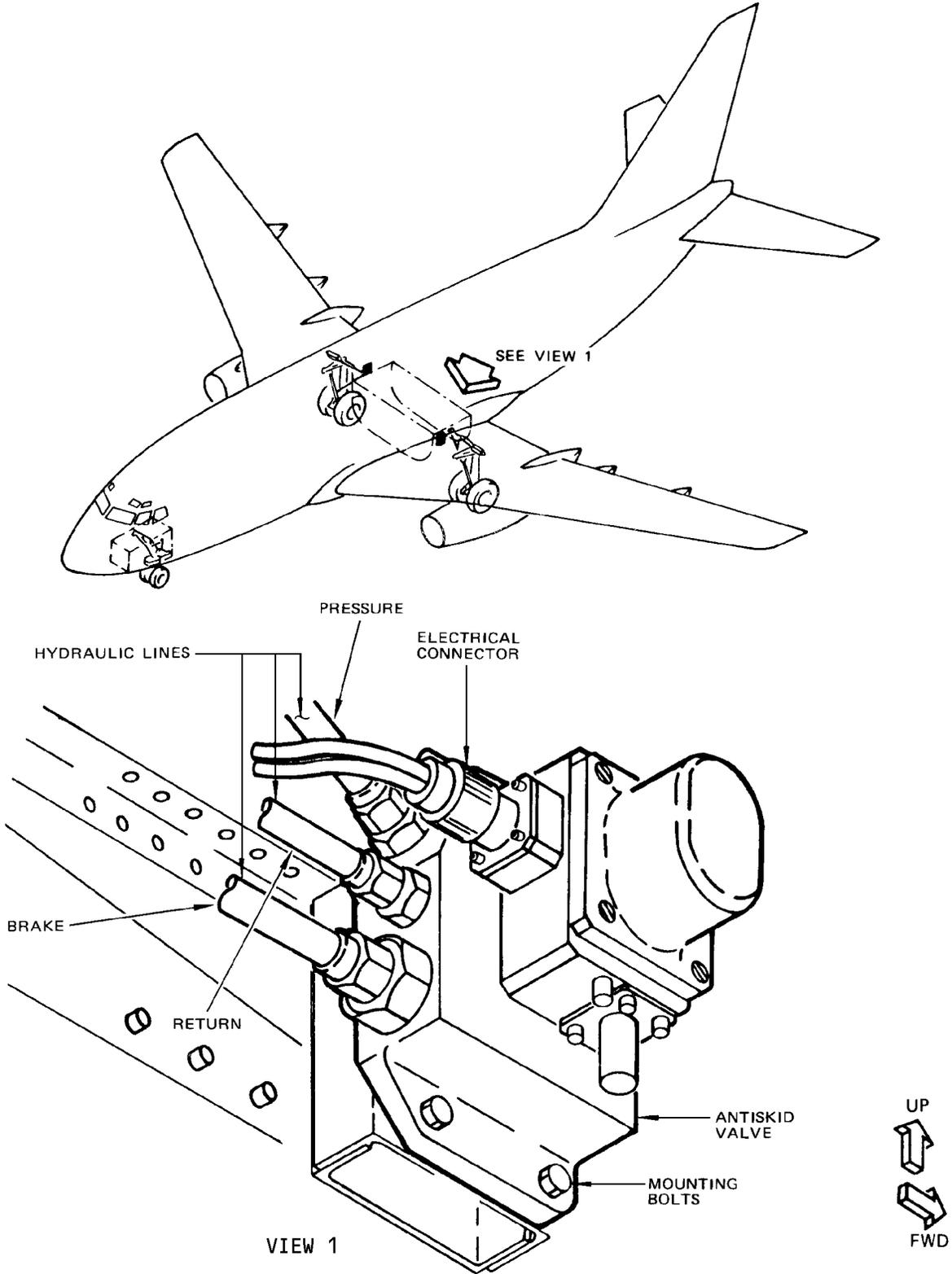
Antiskid Valve Installation
