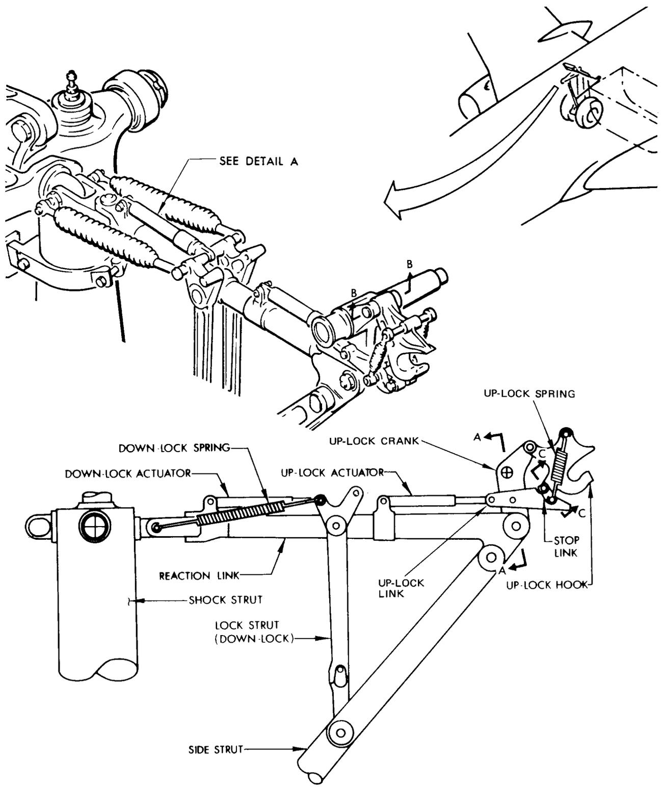
GEAR DOWN AND LOCKED
