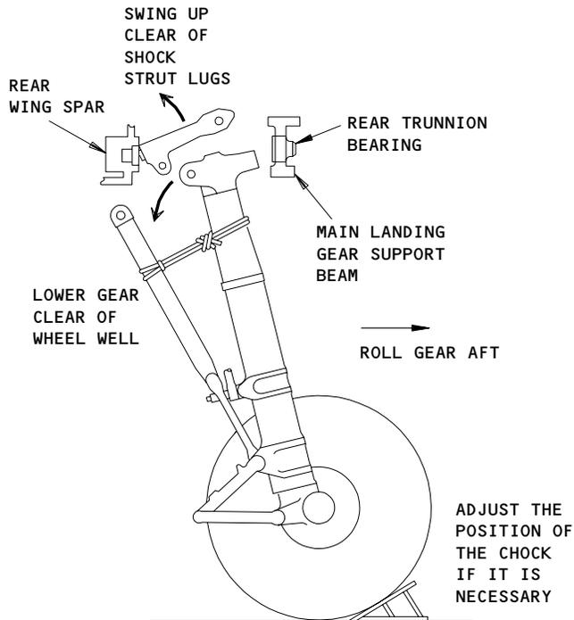
**STAGE 2. REMOVE GEAR FROM REAR TRUNNION BEARING**
