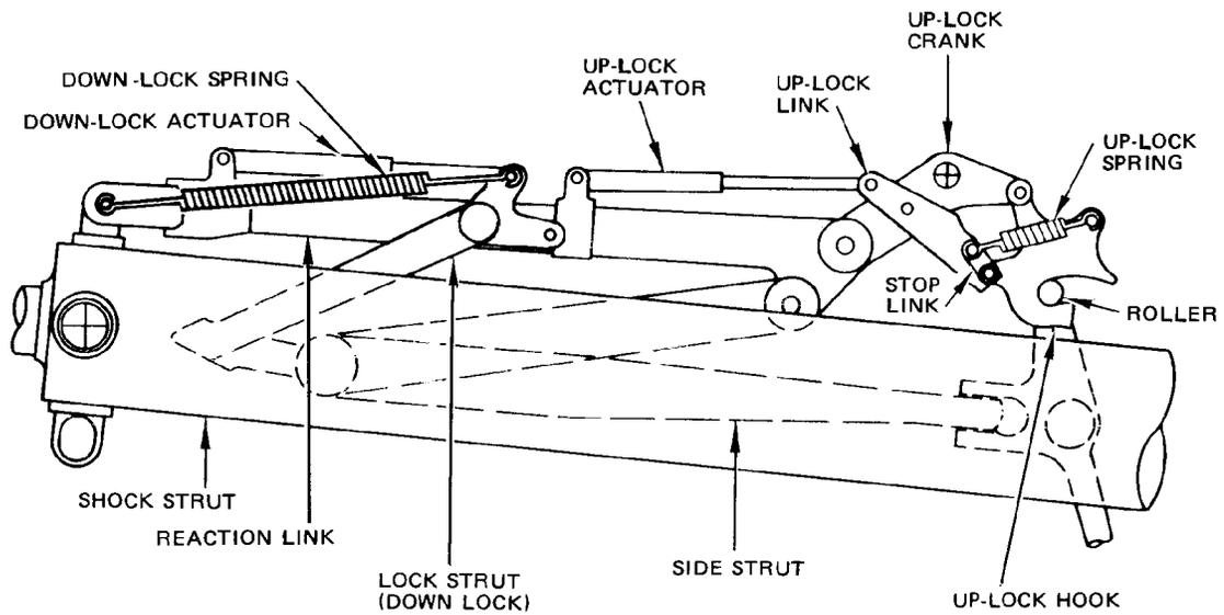
GEAR UP AND LOCKED
