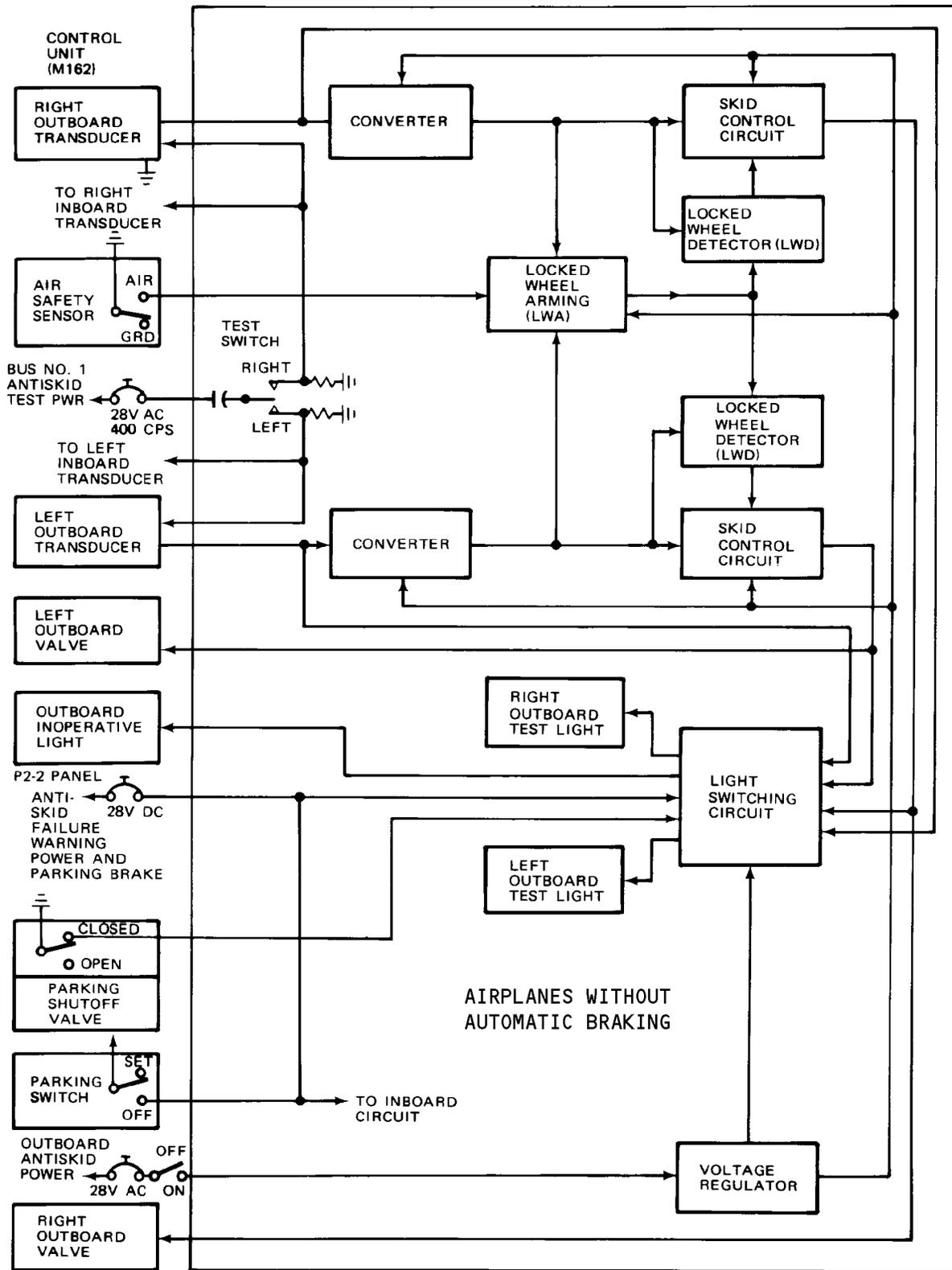
Antiskid System Block Diagram
