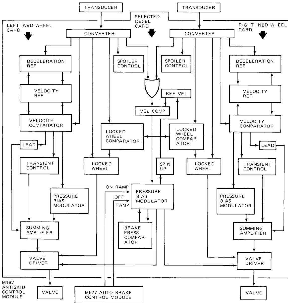
NOTE: INBOARD ANTISKID SYSTEM SHOWN.
